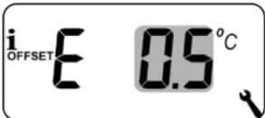
Ajuste la desviación para el sensor de temperatura externo.
