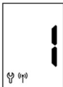
In caso di esito positivo della registrazione, la Web server premium verrà segnalata sul display con un "1". Se entro 2 minuti non avviene alcuna registrazione, sul display apparirà "0".
