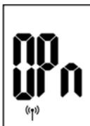
Se viene rilevata una finestra aperta da un Contatto di apertura smart, sul display apparirà il messaggio (OPn) per l'intera durata del processo.
