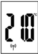
In caso di esito positivo della corsa di installazione, sul display verrà visualizzata la schermata iniziale con la temperatura desiderata.
