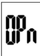
Se viene rilevata una finestra aperta, sul display apparirà il messaggio (OPn) per l'intera durata del processo.
