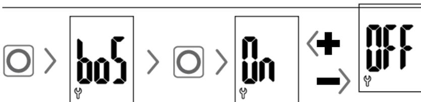
La fonction « boost » permet d'augmenter temporairement le chauffage de la pièce et s'arrête automatiquement au bout de 15 minutes.
