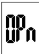
En cas de détection d'une fenêtre ouverte, ce message (**OPn**) apparaît pendant la durée de la procédure.
