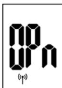
Si el Detector de apertura conectado detecta una ventana abierta, se muestra este mensaje (**OPn**) durante todo el tiempo que dure el proceso.
