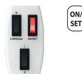
2. Pulse la **tecla 1** para conmutar un sentido de marcha cualquiera (I o II) > y al mismo tiempo (en menos de un segundo) mantenga pulsada la **tecla 2** (tecla de configuración) hasta que el motor tubular suba y baje brevemente (aprox. 5 segundos) a modo de confirmación.
